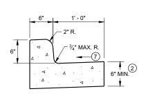
**CONCRETE CURB AND GUTTER 18"**
